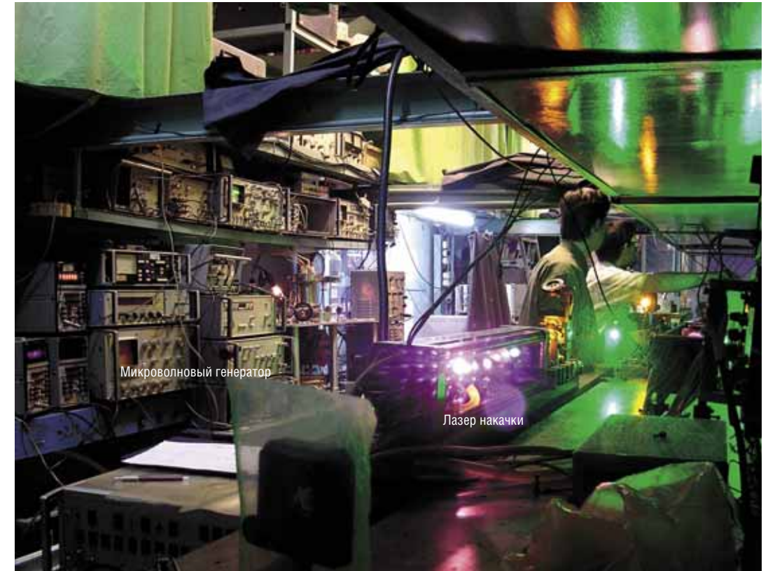
Идет эксперимент по микроволновой спектроскопии ридберговских атомов. На фото видны импульсный лазер накачки для возбуждения ридберговских атомов и микроволновый генератор с системой стабилизации частоты и контроля спектра
